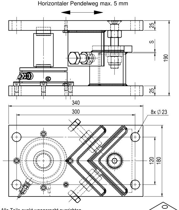
Alle Teile exakt waagerecht ausrichten und verspannungsfrei montieren! Nach Montage das Spaltmaß "S" auf ca. 1mm einstellen.
