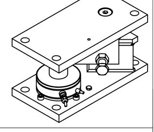
Sonder-Lastecke W1P (W-gespiegelt) für RTE-Wägezelle RLC-28t
