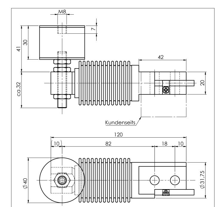
Alle Teile exakt waagerecht ausrichten und verspannungsfrei montieren!
