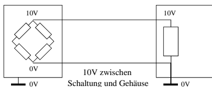
Fig. 19 Separate Erdung von Wägezelle und Anzeiger in angemessener Entfernung voneinander.
